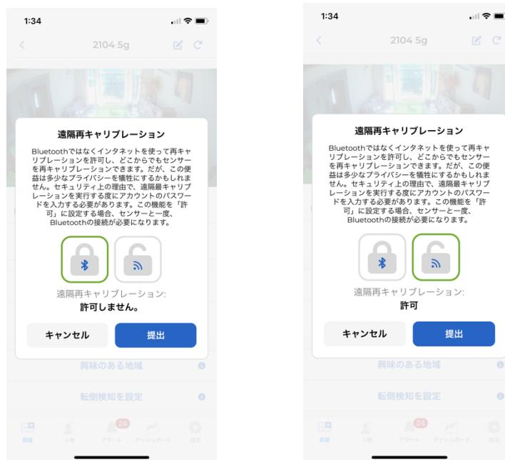
デフォルトでは、リモートキャリブレーションの状態は「拒否」に設定されています。この機能を「許可」に設定するには、一度だけセンサーと Bluetooth 接続する必要があります。ユーザーは、センサーの Bluetooth 範囲内（約 5m または 15 フィート）にいる必要があります。
