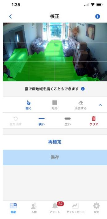
画像内の床の上端は、画像の下端から少なくとも 1/3 の高さになるようにし、床面積は画像全体の 1/4 以上の大さにすることをお勧めします（キャリブレーション時にグリッド線を参照として使用できます）。床面積が小さすぎる場合、システムは以下の警告メッセージを表示します。これがあなたの部屋にとって最良の結果である場合、結果を保存し続けるか、センサーの取り付け高さと角度を調整し、再キャリブレーションをしてください。
